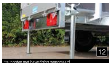
Steunpoten met bevestiging gemonteerd
