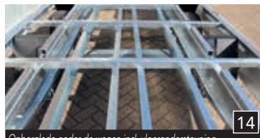
Opbergplaat onder de wagen incl. vloerondersteuning (standaard bij de "Multi"-modellen)
