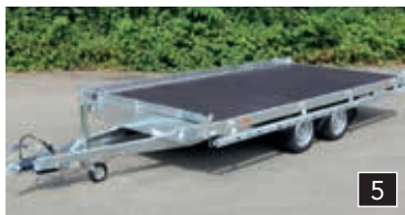
Zonder borden, met reling (Combi Protect Rail, schamierend)
