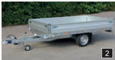
Enkel-assige uitvoering tot maximaal 4050x1800
