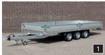
Tridem uitvoering tot maximaal 6050x2400
